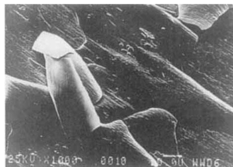
Abb. 12. Aus der molekularen Vorstufe 19 auf Stahl bei 350 °C abgeschiedenes und bei 650 °C im O 2 -Plasma getempertes LiNbO 3 ; rasterelektronenmikroskopische Aufnahme in 1000facher Vergrößerung (aufgrund der unterschiedlichen thermischen Ausdehnungskoeffizienten der Materialien ist die Schicht abgeplatzt).
